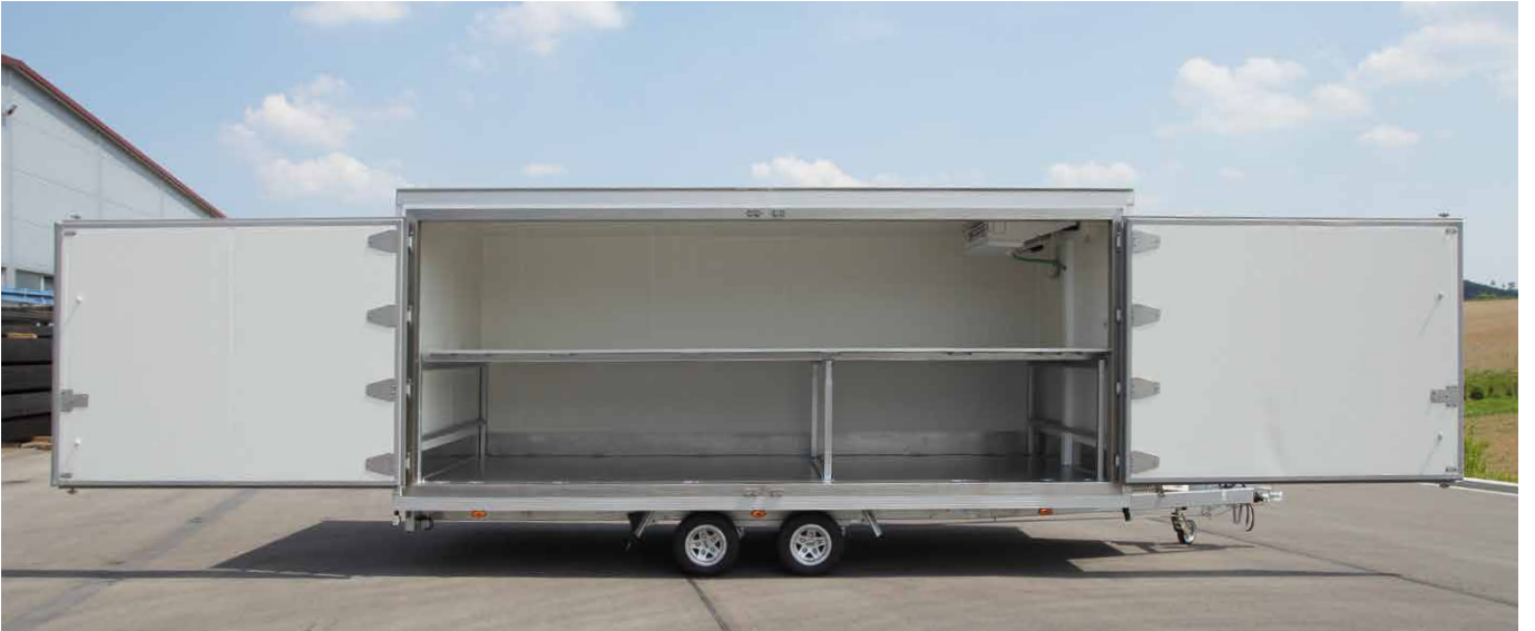
Seitentüre doppelflügelig mit Sonderbau auch über die gesamte Seitenlänge möglich
