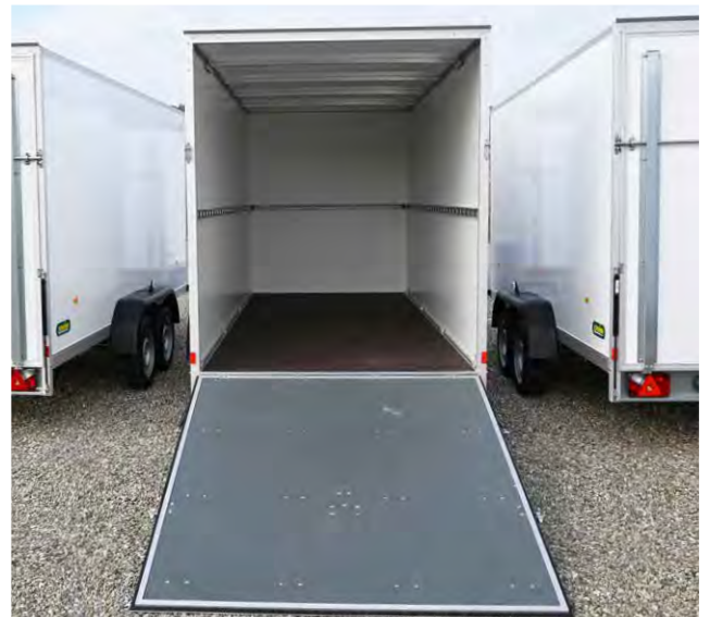
Auffahrklappe mit rutschhemmender Oberfläche
