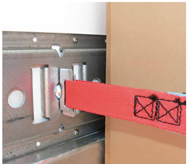
Schlitzankerschiene für Zurrgurte und Sperrstangen
